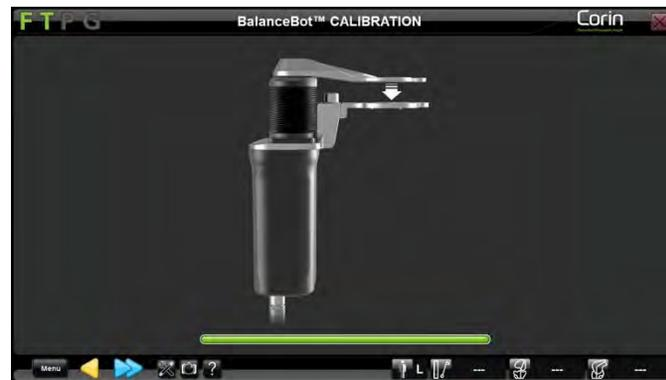
**Hinweis:** BalanceBot muss aus dem Kniegelenk entnommen werden und die tibiale Platte/femorale Paddel müssen fest verschlossen sein. Während des gesamten Prozesses darf keine äußere Kraft auf BalanceBot ausgeübt werden, um die Genauigkeit bei jeder Kalibrierung von BalanceBot zu gewährleisten.
