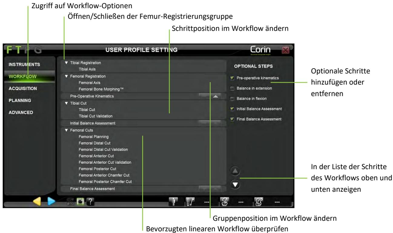
**Ändern des Workflows:** Die Registerkarte „Workflow“ berühren, um den aktuellen Workflow (entsprechend dem ursprünglich ausgewählten Profil) anzuzeigen, der auf Gruppenebene dargestellt wird.
