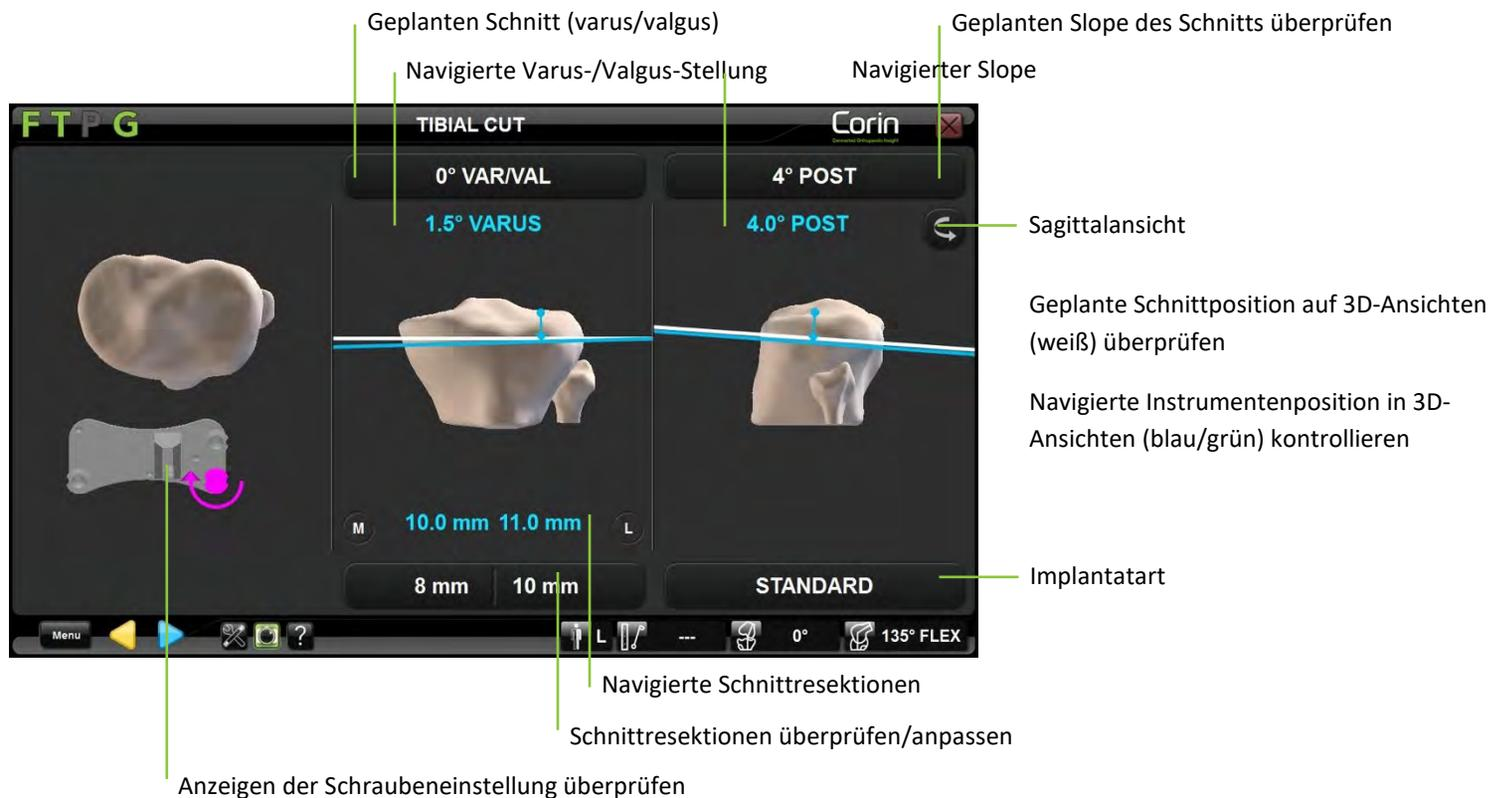
**Implantatart auswählen-** Nur bei Apex Knee: Bei Bedarf und Verwendung der Option Tibia-Einzelpunkt-Registrierung (keine Tibiaplanung), die „Standard“-Taste berühren und dann </> berühren, um die Implantatart auf „Modular“ zu ändern.
