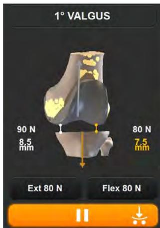
Wenn im Kraftkontrollmodus die Lücken so eng sind, dass die femoralen Paddel unter der angewiesenen Kraft die tibiale Platte berühren, wird die Play/Pause-Taste des BalanceBot orangefarben und zeigt an, dass der BalanceBot überlastet ist. Diese Warnung wird ausgeblendet, sobald sich Lücken von mindestens 8 bis 9 mm öffnen, je nach verwendeten Einsatzproben.
