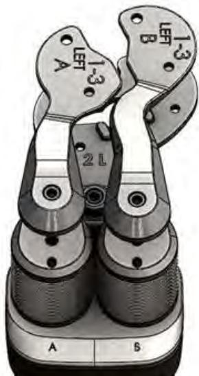
Das richtige Paar (A+B) an femoralen Paddeln in Größe und Seite (#NS-5022L-A bis NS-5022L-B) auswählen und mit einem H 3.5 -Schraubenzieher (#KS-62030) an jeder der beiden Achsen von BalanceBot (#NS-52000/NS-52900) befestigen. Paddel A passt zu Achse A und Paddel B zu Achse B.
