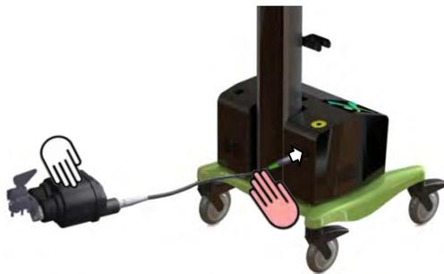
OMNIBot und den größten Teil des Anschlusskabels auf dem Operationstisch belassen und das grüne Hülsenende des Kabels an unsteriles Personal übergeben, um es mit dem grünen ID-Ring am Anschluss von OMNIBot der OMNIBotics Station zu verbinden. Der rote Punkt am Stecker muss mit dem roten Punkt am Steckeranschluss der Station übereinstimmen.
