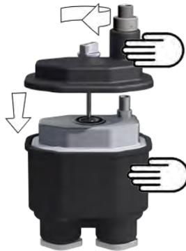
3. Das Gehäuse von OMNIBot mit der Gehäuseabdeckung von OMNIBot (#4144-4000 oder NS-42000) schließen und mit der Schraube sicher fixieren.
