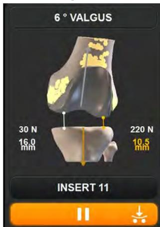
Wenn im Höhenkontrollmodus die auf BalanceBot ausgeübte Kraft 200N erreicht, leuchtet die Play/Pause-Taste des BalanceBot orangefarben auf und zeigt an, dass der BalanceBot überlastet ist. BalanceBot Spacer kann eine solche Last für 15 Sekunden unterstützen. Diese Warnung wird ausgeblendet, sobald die auf den BalanceBot ausgeübte Kraft kleiner als 200N ist.
