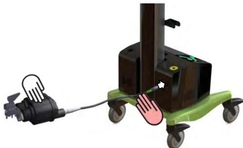
OMNIBot und den größten Teil des Verbindungskabels auf dem Operationstisch belassen und das andere Ende des Kabels an unsteriles Personal übergeben, um es mit dem Anschluss von OMNIBot an der OMNIBotics Station zu verbinden. Der rote Punkt am Stecker muss mit dem roten Punkt am Steckeranschluss der Station übereinstimmen.
