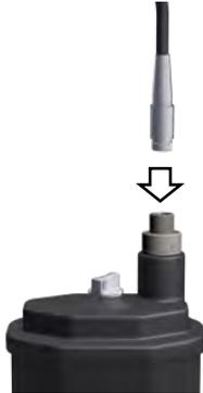
Den graue Kabelhülse von OMNIBot (#4144-5000) an die Abdeckung von OMNIBot (#4144-4000) anschließen. Der rote Punkt auf dem Kabelstecker muss mit dem roten Punkt auf dem Anschlussabdeckung übereinstimmen.
