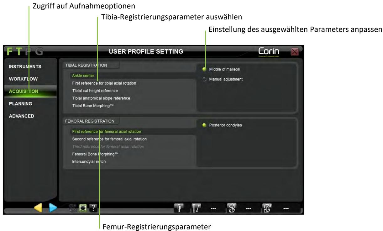
**Ändern der Aufnahmen:** Durch Berührung der Registerkarte „Aufnahme“ den Registrierungsparameter auswählen, um ihn anzuzeigen oder zu ändern.
