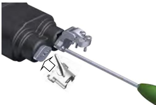
Die Schnittstelle für die Ausrichtungsanpassung (#4145-2000) mit einem H3,5-Schraubendreher an der Vorderseite der entsprechenden Achse (#1) befestigen.
