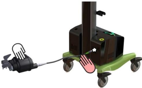
Mantenha o OMNIBot e a maior parte do cabo de ligação sobre a mesa de operações e entregue a ponta verde do cabo ao pessoal não estéril para ligação ao conector OMNIBot correspondente com o anel verde na Estação OMNIBotics. O ponto vermelho no conector deve ficar alinhado com o ponto vermelho na porta de ligação da Estação.
