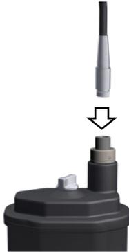
Ligue a manga cinzenta do Cabo do OMNIBot (#4144-5000) à Tampa do OMNIBot (#4144-4000). O ponto vermelho no conector do cabo deve ficar alinhado com o ponto vermelho no conector da tampa.
